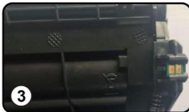
Nakon postavljanja čipa umetnite toner u pisač. Ukoliko printer javlja poruku: „TONER CARTRIDGE IS NOT RECOGNISED“ provjerite da li ste ispravno montirali čip kako je prikazano na slikama.
